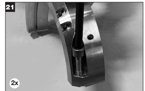
Lubrique las roscas con un compuesto antiadherente recomendado e instale los tornillos de seguridad del soporte en la mitad del soporte rotativo.
