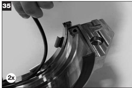
Aplique una película delgada de grasa a las mitades del O-Ring estacionaria e instale en las mitades de la brida; asegúrese de que las uniones del O-Ring sobresalgan de manera uniforme a ambos lados.
