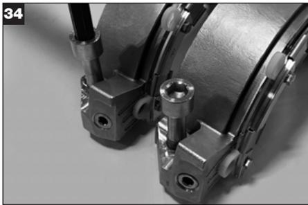
Instale los tornillos de seguridad de la brida en las mitades de la brida (2x). **Nota:** Los tornillos de seguridad de la brida se instalan en un extremo de cada mitad de la brida, en los extremos alejados de la ranura del perno de montaje.
