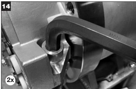
Alternativamente apriete los tornillos de seguridad de la brida al torque especificado (consulte la **Tabla 4 - Valores de Torque de los Tornillos de la Brida**).
