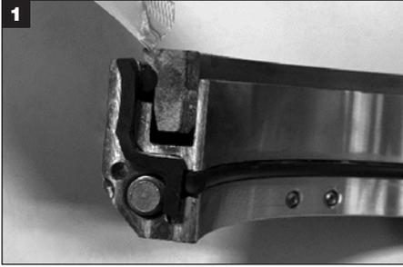
El eje del equipo debe limpiarse y engrasarse antes de la instalación del soporte rotativo. Aplique la grasa suministrada solamente a las uniones de la cara. No aplique grasa a los extremos del O-Ring. **Precaución:** Las partículas de suciedad en las uniones de la cara del sello pueden causar fugas. El soporte rotativo no debe rotarse en el eje durante los Pasos 2 a 4 ya que puede provocar fugas en el eje y/o daños en la cara.
