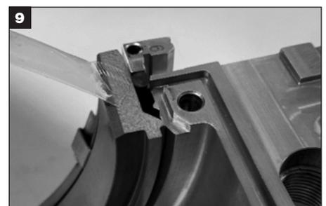
Aplique la grasa suministrada únicamente a las uniones de la cara estacionaria. No aplique grasa a los extremos del O-Ring. **Precaución:** Las partículas de suciedad en las uniones de la cara del sello pueden causar fugas.
