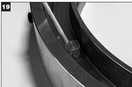
Recoja el tubo de accionamiento (use tenacillas si es necesario) e instálelo en la oreja del soporte. Asegúrese de que el tubo de accionamiento esté completamente asentado en la oreja.
