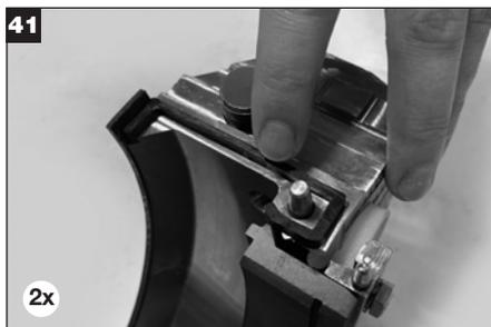
Aplique una película delgada de grasa a las juntas de la brida e instale en las ranuras de las mitades de la brida. **Nota:** Las juntas de la brida deben instalarse en el extremo de la brida donde sobresale la junta de la cara de la caja.
