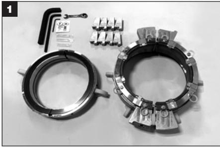
Retire el sello del embalaje y colóquelo sobre una superficie de trabajo limpia. Asegúrese de que estén asentados los espaciadores de instalación en el diámetro exterior de las mitades del soporte rotativo. **Importante:** ¡NO aplique pegamento a los O-Rings, al soporte ni a las medias juntas de la brida!
