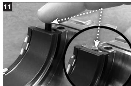
Asegúrese de que los extremos del O-Ring estacionario estén al ras, pero no debajo de las uniones de la cara estacionaria. Haga presión cuidadosamente en los extremos del O-Ring si sobresalen más allá de las uniones de la cara. La preparación está completa; continúe con **Instalación del Sello**.
